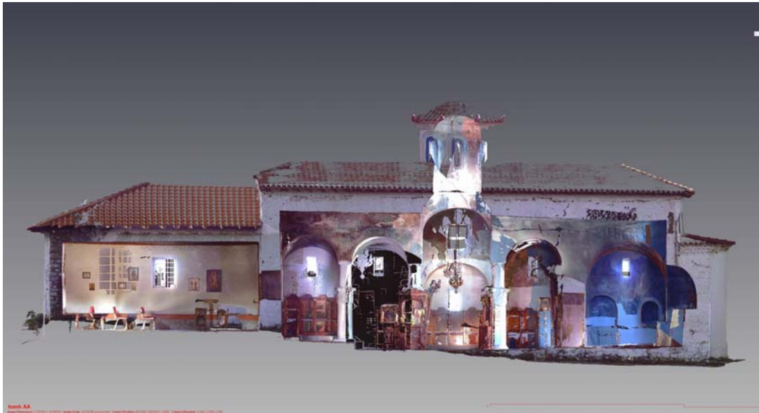
Εικόνα 5. Ορθοεικόνα τής διαμήκουσ τομής του κτηρίου (A-A').
